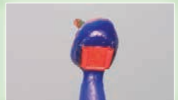
Колпачки с основанием-направляющей из беззольной пластмассы с литниками готовы к паковке
