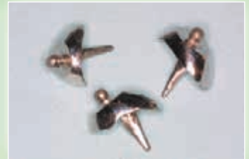
Монолитье: отлитые вместе штифт-шляпка и сфера. Помимо сохранения параллельности, сферы могут быть установлены в смещенном положении относительно оси штифта
