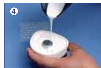
После установки магнитной чашки с магнитом - заливка вторичного цоколя.
