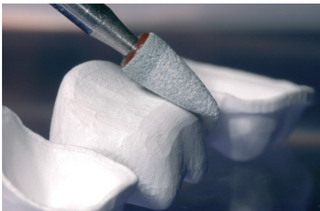
Закруглите острые углы и грани, образовавшиеся при фрезеровании.
