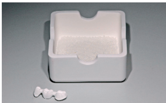
Лоток для обжига заполнен 100 г ZrO 2 -дробью
