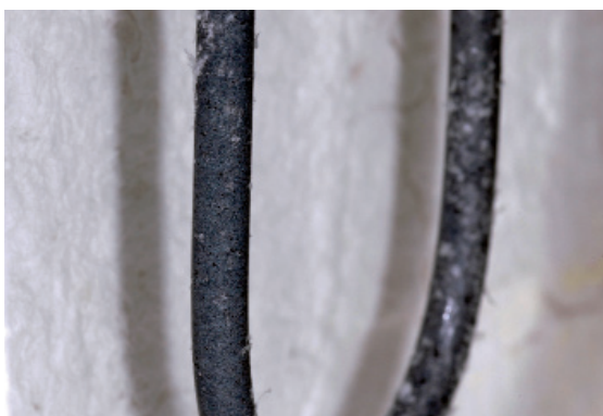
Загрязненный сильно корродированный нагревательный элемент
