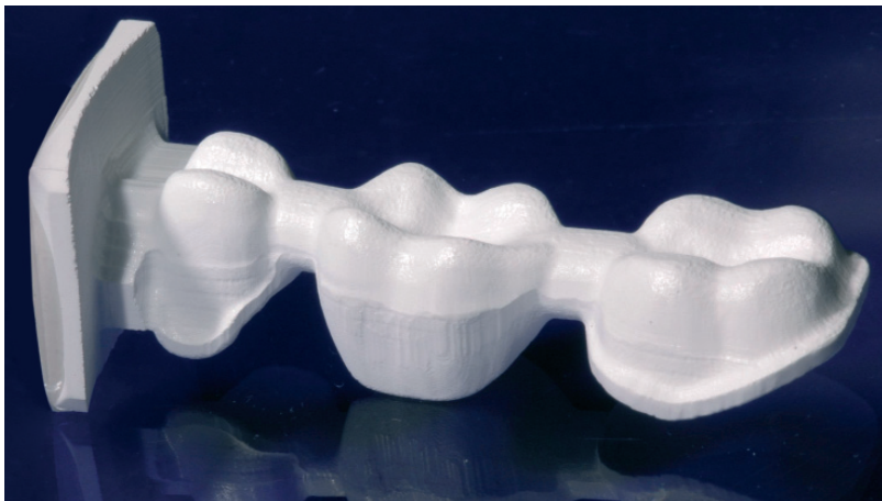
Отфрезерованный каркас из IPS e.max ZirCAD
