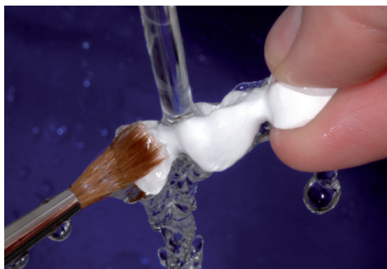
Тщательно смойте фрезеровочную крошку с каркаса под проточной водой. При необходимости воспользуйтесь щеткой.
