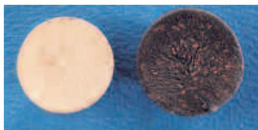
На этой фотографии можно увидеть результат плавки одного и того же сплава в натуральной и инертной среде.
